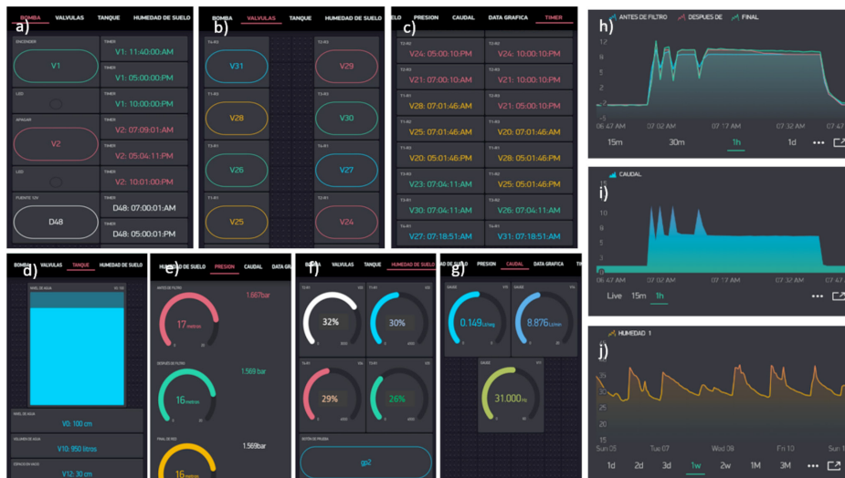
Figura 3. Control de bombeo (a), control de electroválvulas (b), programación de riego (c), nivel de agua (d), presión del sistema (e), humedad de suelo (f), caudal de sistema (g), data histórica de presión (h), data histórica de caudal humedad de suelo (i), data histórica de humedad de suelo (j).
