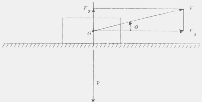
Sean  $F_1$  y  $F_2$  las componentes de  $F$  en las direcciones horizontal y vertical, respectivamente. La fuerza de compresión (normal a las superficies en contacto) es  $P - F_2$ , por lo que llamando  $\mu$  al coeficiente de rozamiento estático entre ambos materiales, (que es una constante dados los materiales del cuerpo y la superficie), se tiene
