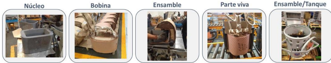
Fig. 3. Ensamble transformador monofásico.
