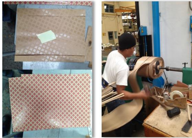
Fig. 8. Papel dieléctrico proveedor W y C.
