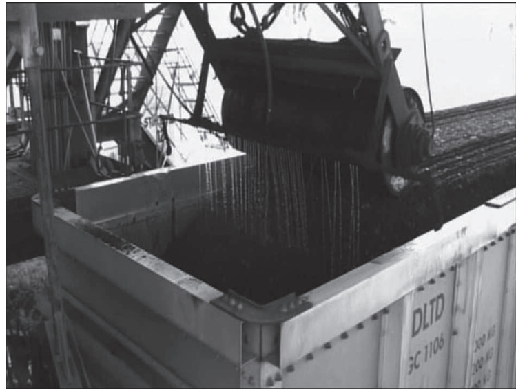
Foto 15. Humectación de vagón de carbón por asperción.
