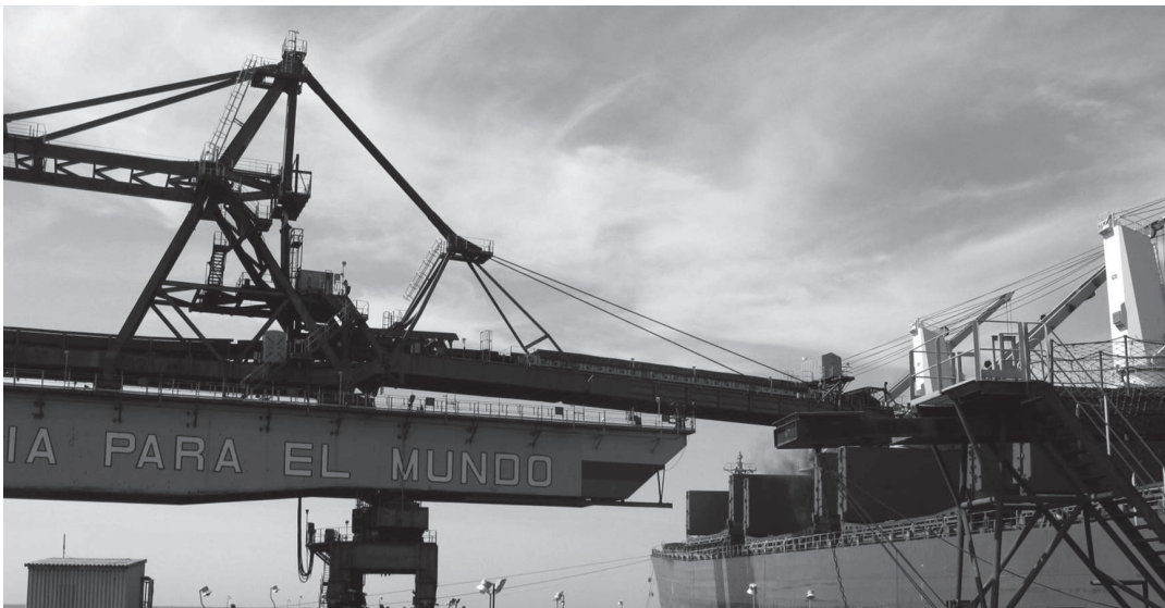
Foto 16. Cargue directo de carbón en buques (Banda transportadora, Cargador de buques y Buque) Fuente: Geól. Édgar E. Roa A.
