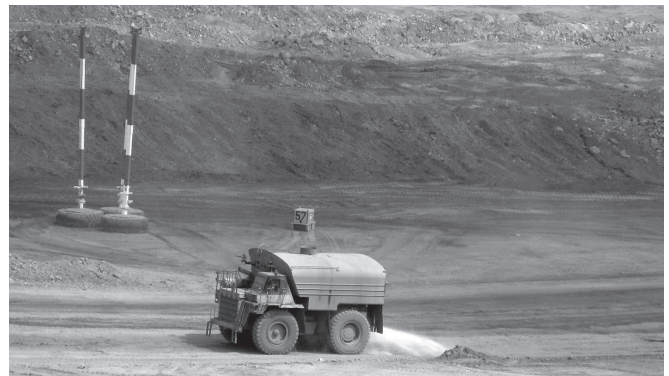
Foto 10. Tanque de riego para mantenimiento de vías (Tanquero)
