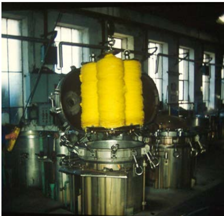
Figura 8. Extracción del portamaterias de un autoclave, con las bobinas de peinado teñidas en el Tinte de Gutiérrez.
