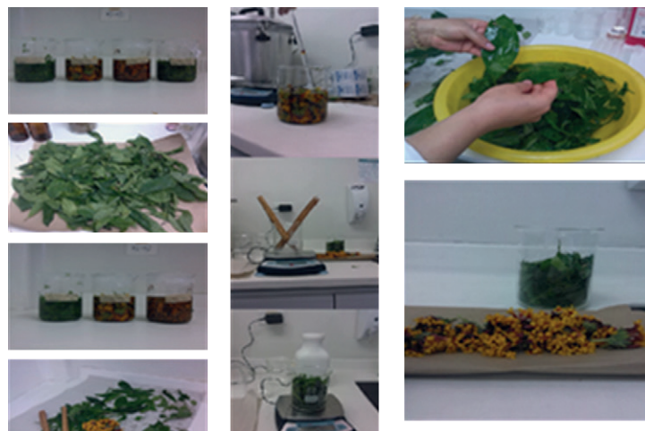
Figura 1. Preparación del material vegetal a) lavado, b)secado, c)pesaje y d)extracción
