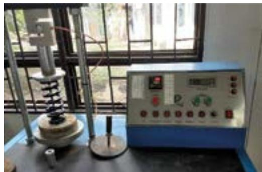
**Figura 5.** Prueba del coeficiente de elasticidad .
