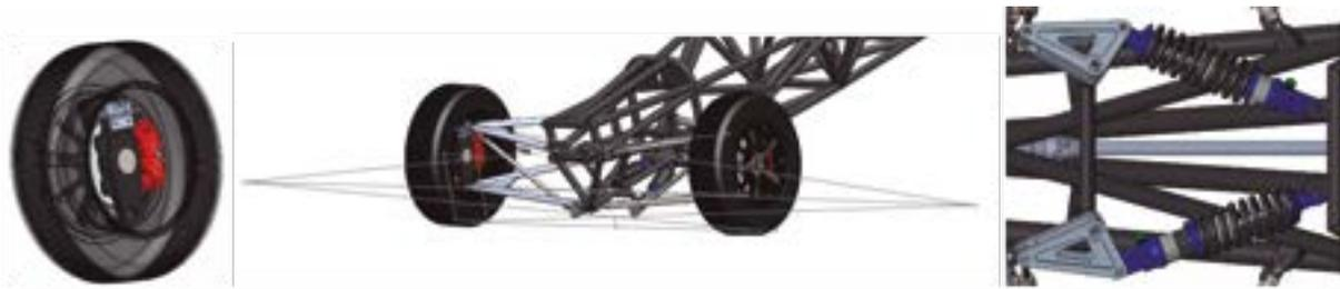
**Figura 2.** Dimensionamiento de la suspensión. (a) Neumáticos y componente, (b) Tijeras, (c) resortes, balancines, soportes en el chasis y acoples. Fuente: elaboración de los autores.
