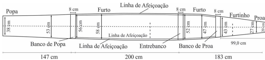
Figura 8: Vista lateral depois de realizados os procedimentos de afeição e cavoucar a boca da canoa.
