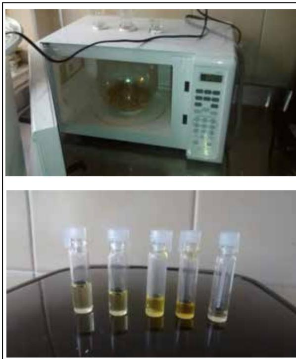
Figura 1. Hidrodestilación asistida por la radiación de microondas (MWHD) de aceite esencial de jengibre.
