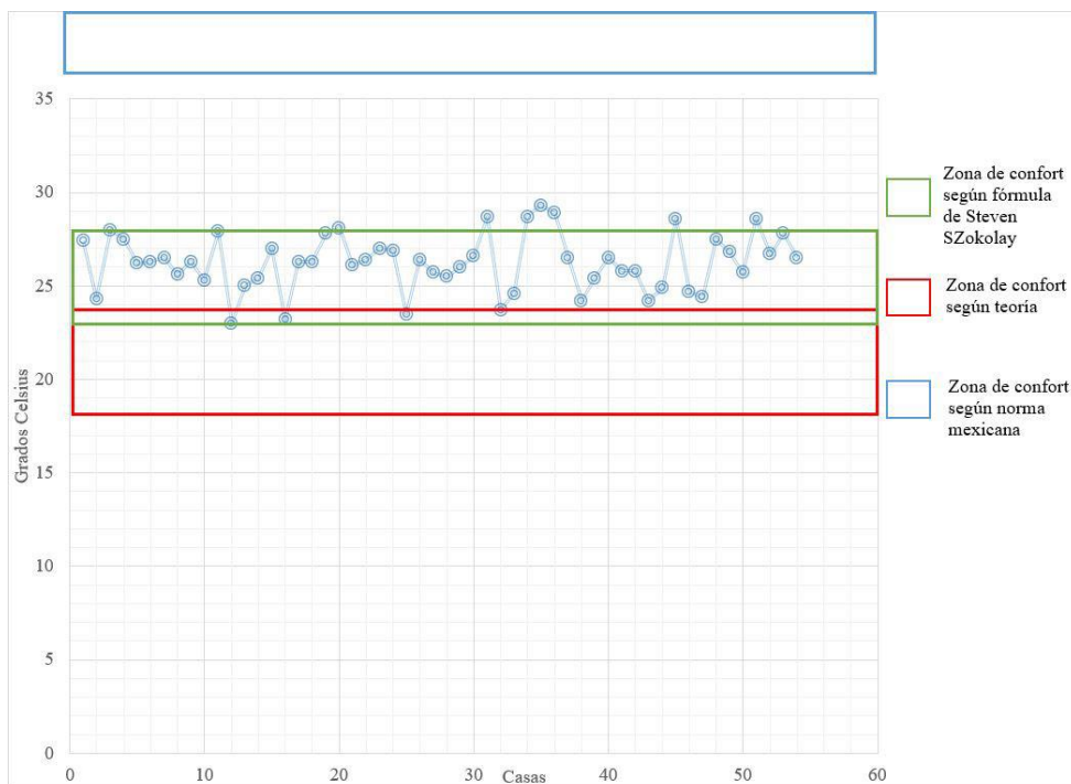
Figura 7. Monitoreo in situ del estrés térmico. Fuente: Elaboración propia.
