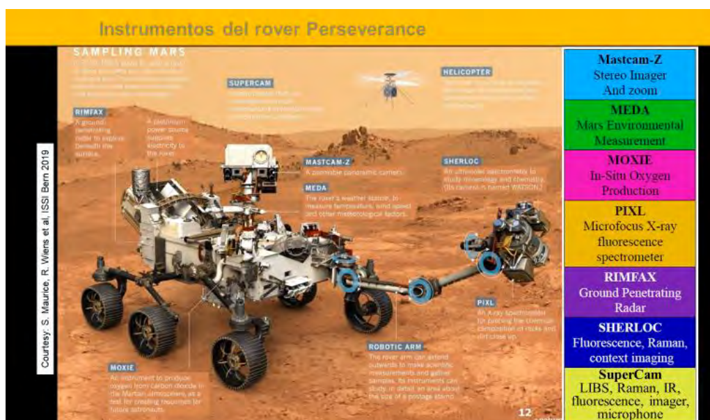
Figura 6. Instrumentos a bordo del rover Perseverance con un listado de las técnicas.
