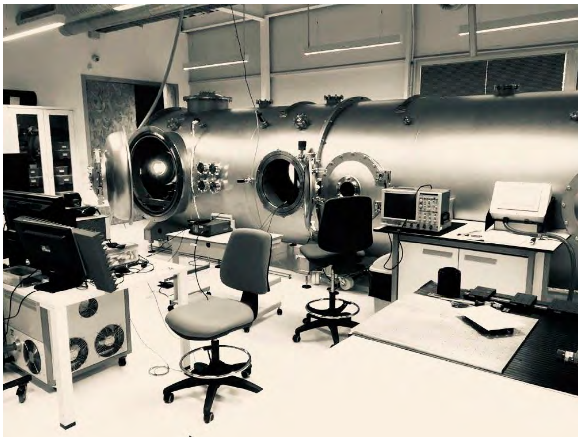
Figura 12. Imagen de la cámara de vacío térmico del laboratorio UMA LaserLab que permite reproducir la presión, composición y temperatura de la atmósfera en Marte.
