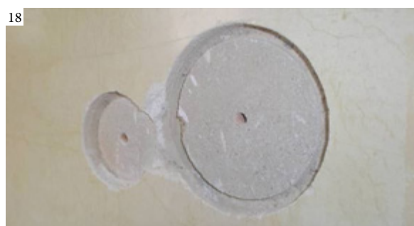
Figura 19: Toma de muestras del estuco al fuego hallado en los paramentos del Ministerio del Aire, Madrid, para proceder a su análisis fisicoquímico (González Yunta 2016: 125)
