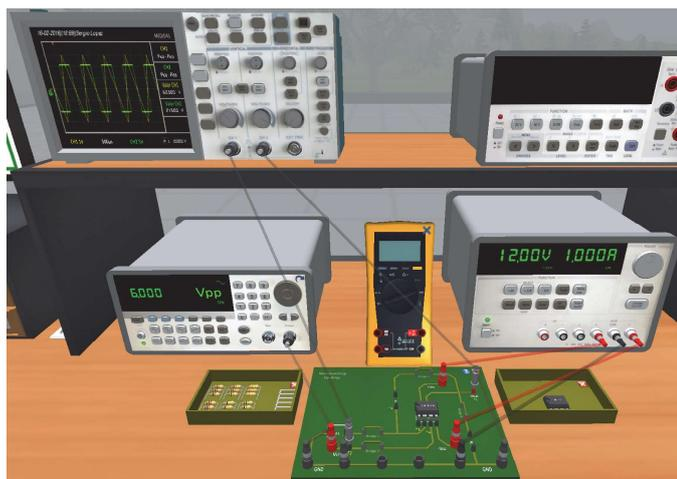
Fig. 10. Montaje y prueba de un circuito comparador con eLab3D
