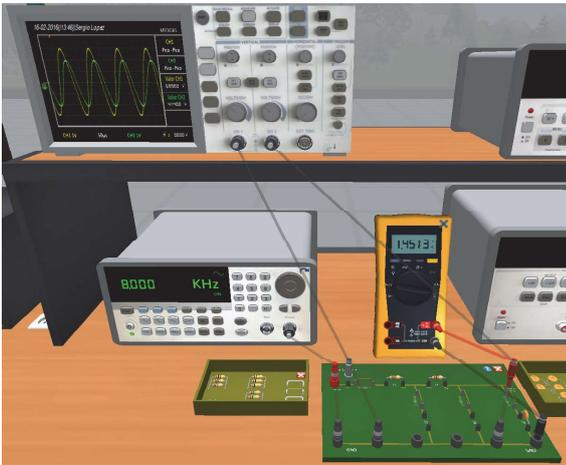
Fig. 14. Montaje y prueba de un filtro paso bajo con eLab3D
