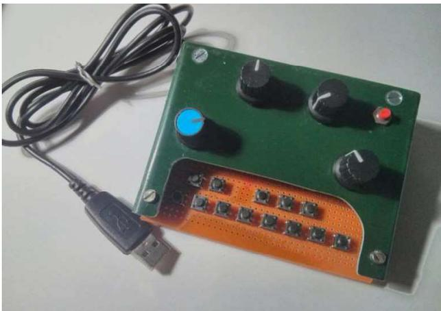
**Figura 3. Controladora MIDI como trabajo de la asignatura Sistemas Electrónicos.**
