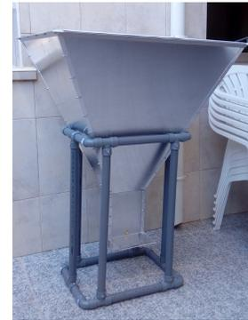
Figura 5. Antena de bocina descansando sobre el soporte.
