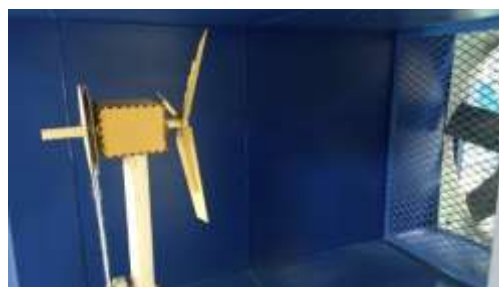
Fig. 11. Aerogenerador dentro del túnel de viento.
