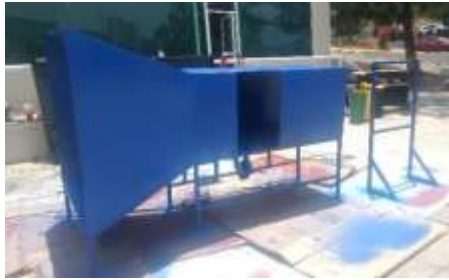
Fig. 6. Detallado y pintado del túnel de viento.
