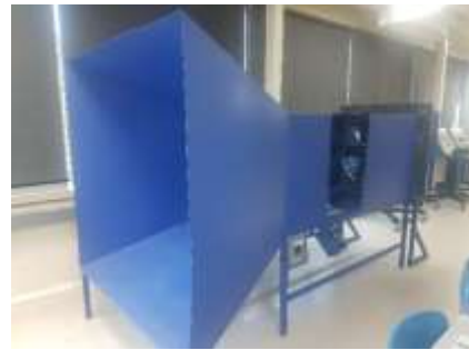
Fig. 8. Túnel de viento construido (vista de frente).
