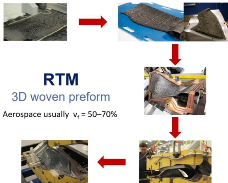
Figura 13. Proceso general para la fabricación de un fan blade a través de RTM.
