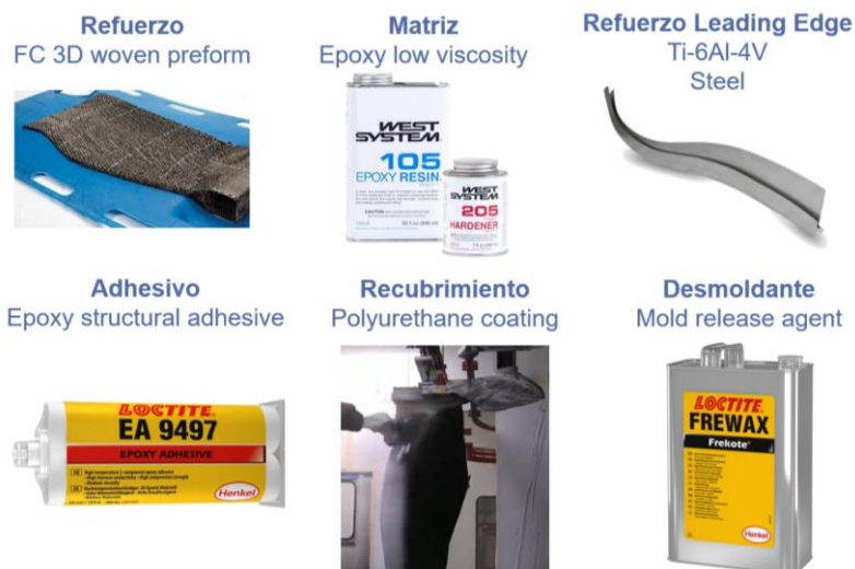
Figura 15. Materiales e insumos para la fabricación de un fan blade a través de RTM.
