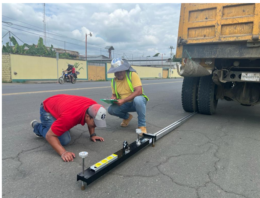
Figura 2. Toma de lectura con el deflectómetro viga Benkelman
