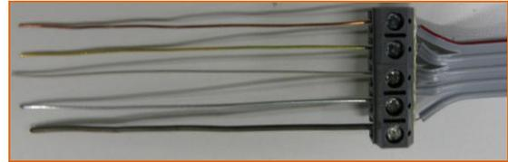
**Figura 5. Electrodo Metálicos**
