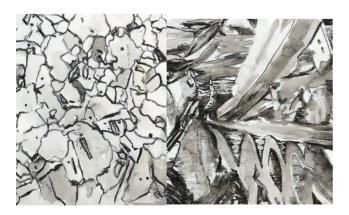
**FIGURA 1.** Se muestran los esquemas de la fase austenita (izquierda) y la fase martensita (derecha), en una aleación con memoria de forma.
