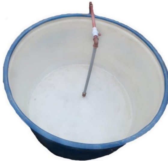
Figura 1. Tanque con tubería PVC perforada en el extremo como sistema de aireación.
