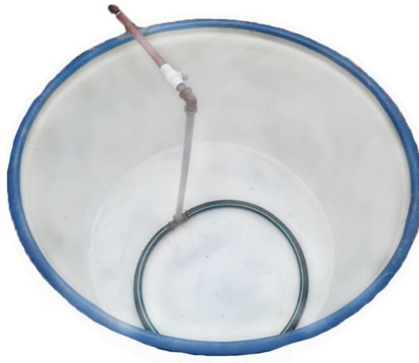
Figura 2. Tanque con manguera difusora como sistema de aireación.
