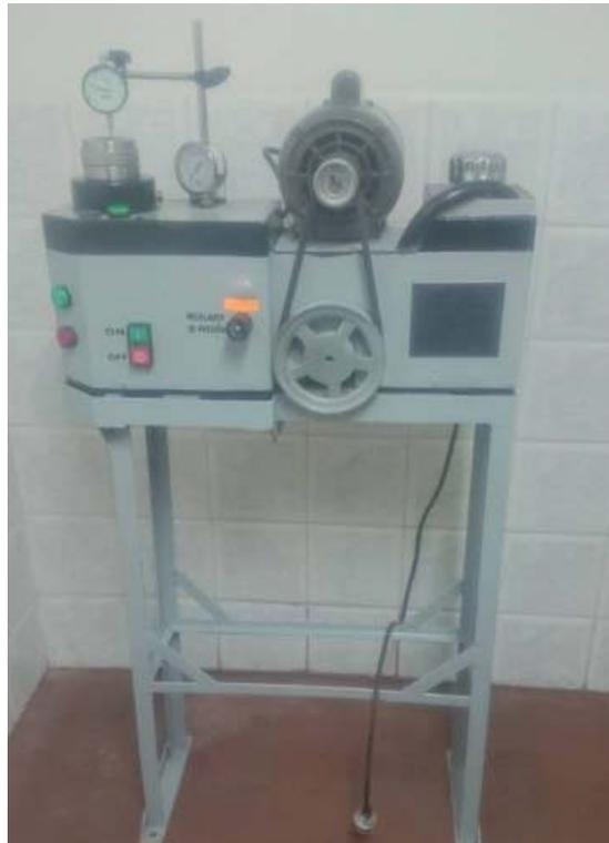
**Figura 2.** Lastómetro implementado. Fuente: elaboración propia.
