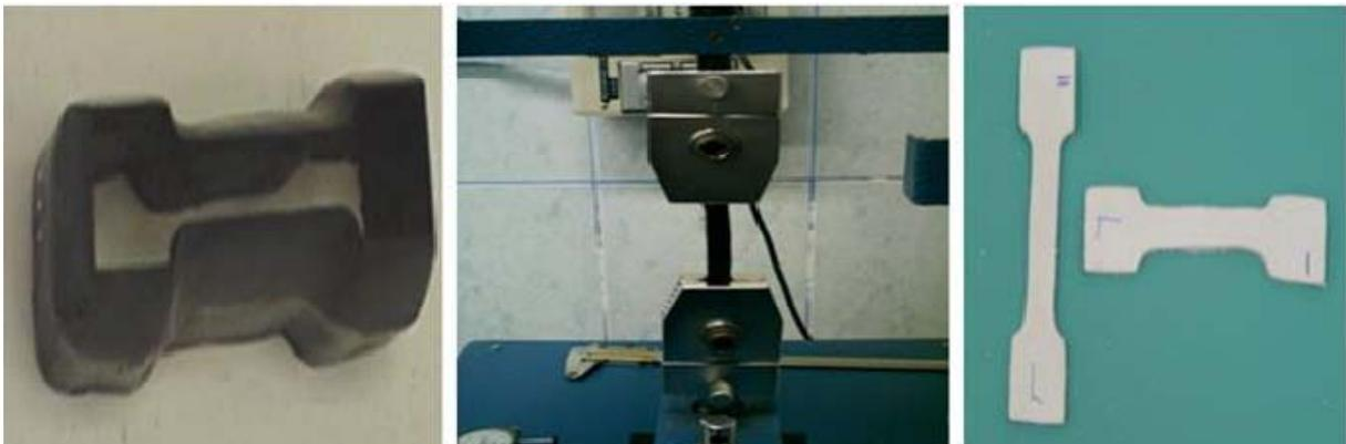
**Figura 1.** Troquel y probeta mediana del cuero. Fuente: elaboración propia.
