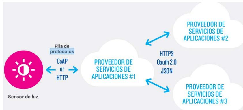
Figura 4. Modelo de conectividad intercambio de datos a través del back-end
