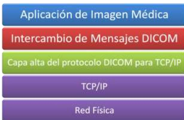
Fig. 1 Arquitectura de Red del Modelo DICOM.
