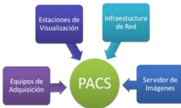
Fig.2 Componentes de un PACS.
