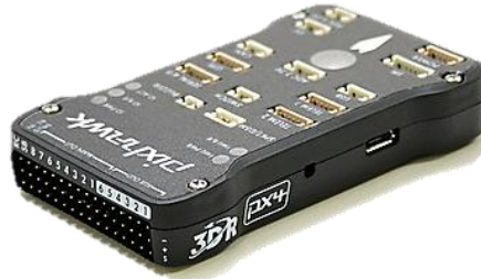
Figura 13. Controlador de vuelo. Fuente: Elaboración Propia (2016)
