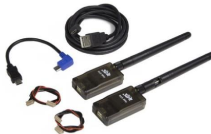
Figura 20. Sistema de Telemetría. Fuente: Elaboración Propia (2016)
