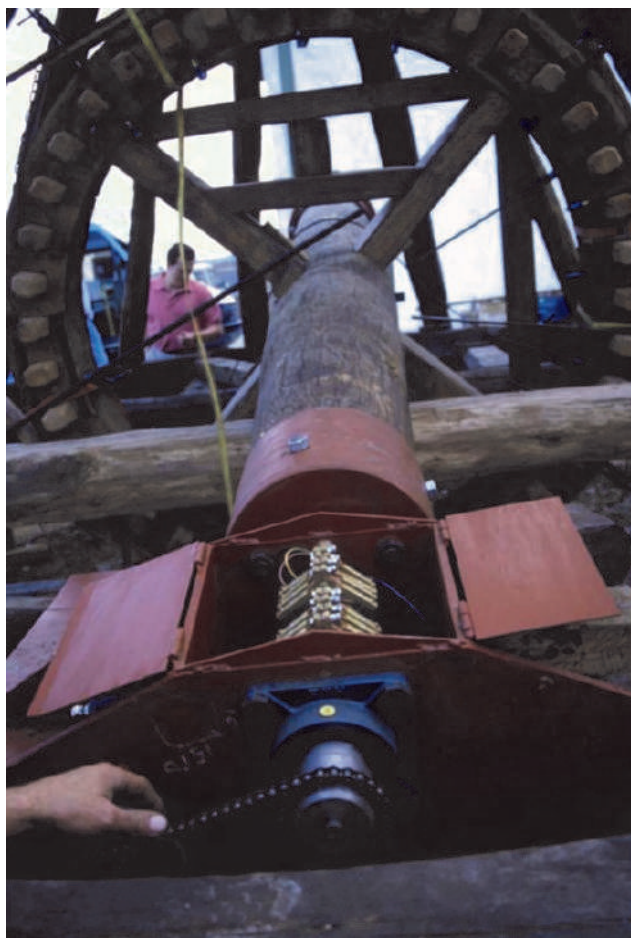
Apoyo del eje en la piedra y paso de corriente para los motores de plegado de velas.
