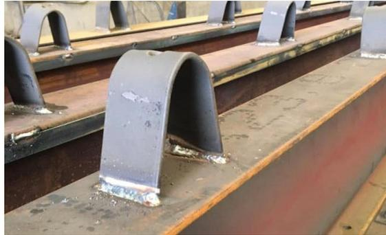
**Fig.4.** Soporte de fijación.
