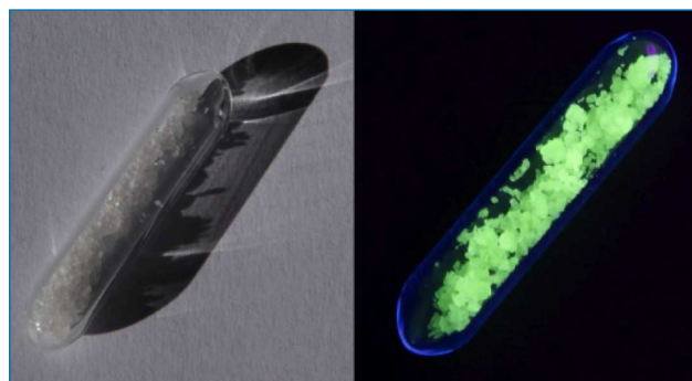
Figura 2. Crisoles de sulfato de terbio(III) (izda.) y su emisión verde bajo iluminación de luz UV (dcha.) [5]
