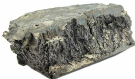
Figura 1. Muestra de terbio metálico de 235 g de alta pureza (99,9 %) [3]
