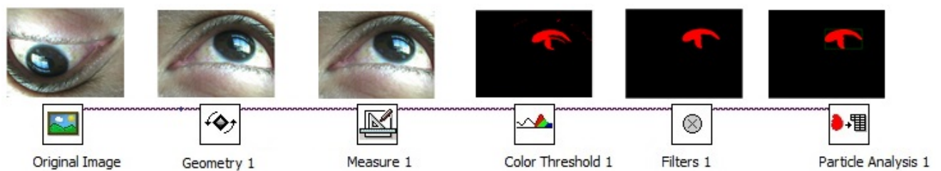
Figura 1. Bloques de las Funciones de procesamiento de imágenes, e imágenes resultantes del proceso. Software NI Vision Assistant - National Instruments.
