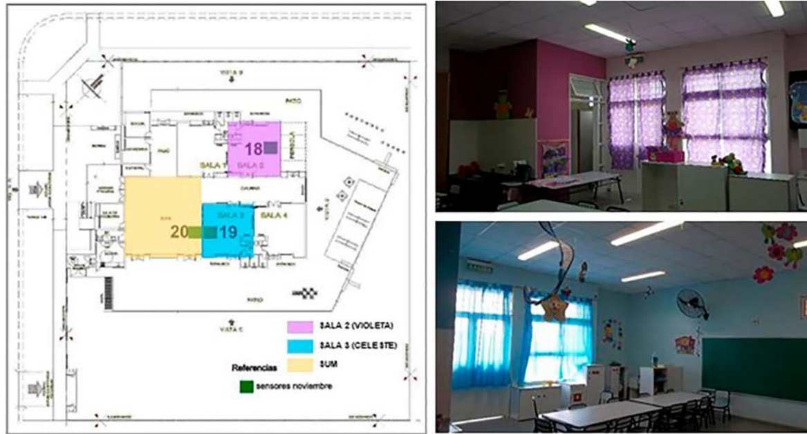
Figura 5. Izq.: Esquema de monitoreo JI 174. Período 12/11/12 – 19/11/12. Der.: Interiores Sala 2 (Violeta), con ventanas hacia el NO, y Sala 3 (Celeste), con ventanas hacia el SE.
