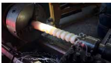
Ilustración 3.- Construcción del tornillo sin fin en el torno paralelo.
