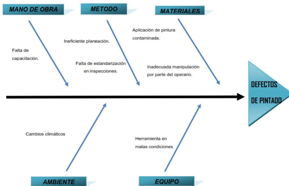
Figura 1. Diagrama de Ishikawa de las causas potenciales que originan los defectos. Fuente propia
