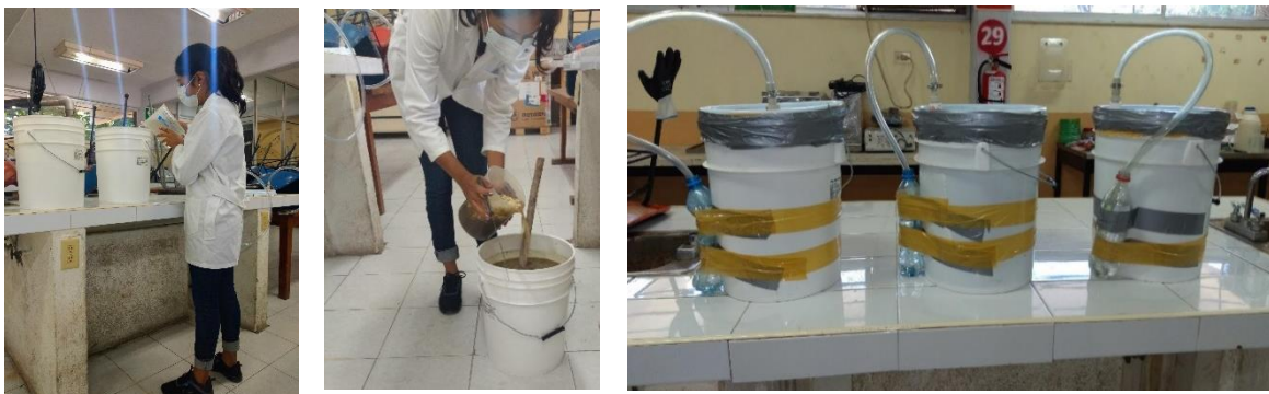
Figura 5. Preparación de la mezcla y montaje de los biodigestores para la producción del segundo biofermento
