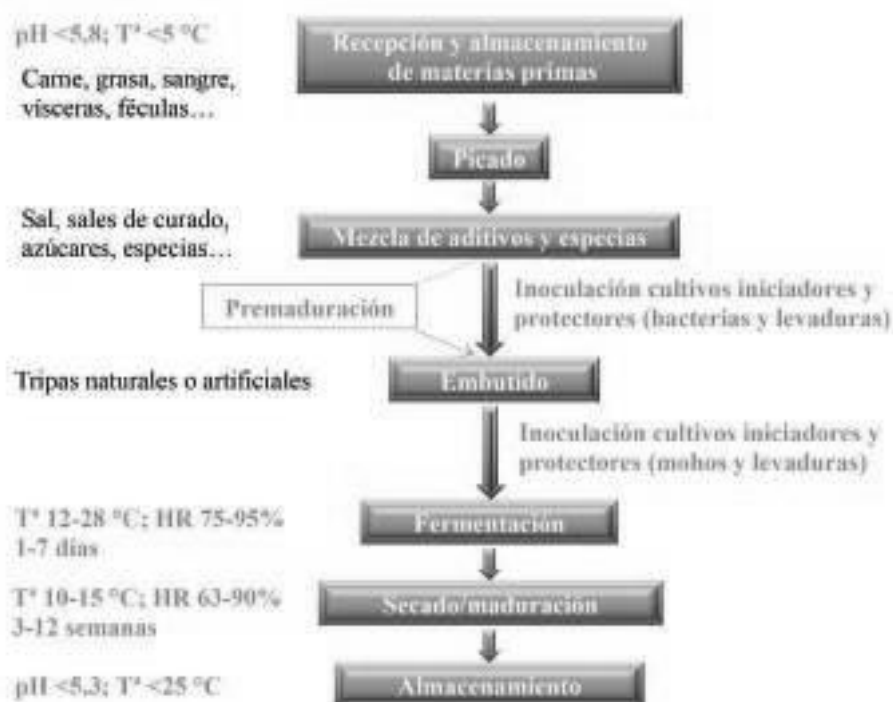
Figura 1. Diagrama de flujo del procesado de los embutidos curado-madurados
