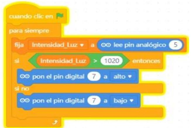
**Figura 6:** Programación placa Arduino y sensor LDR.
