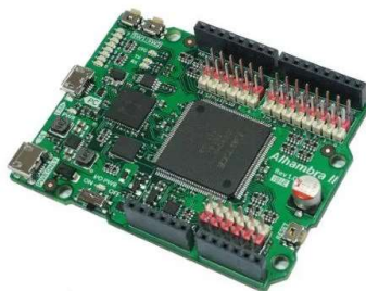
Fig. 3. Placa Icezum Alhambra II de la empresa AlhambraBits®.
