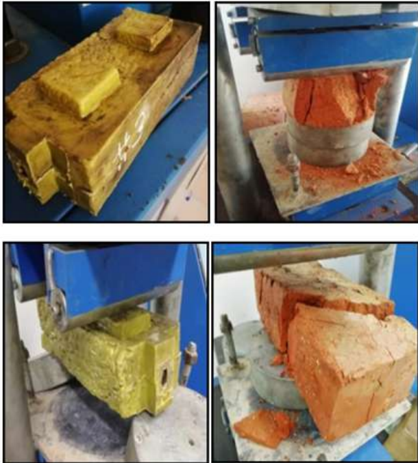
Figura 9. Ensayo de flexión aplicado a los ladrillos de plástico y a los convencionales
