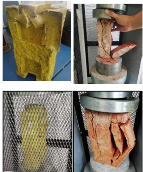
Figura 8. Ensayo de compresión aplicado a los ladrillos de plástico y convencionales
