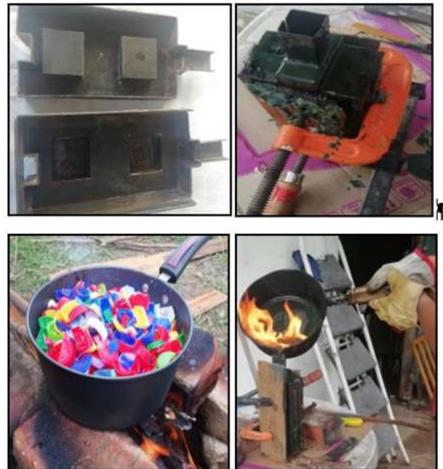
Figura 5. Proceso manual de fundición
