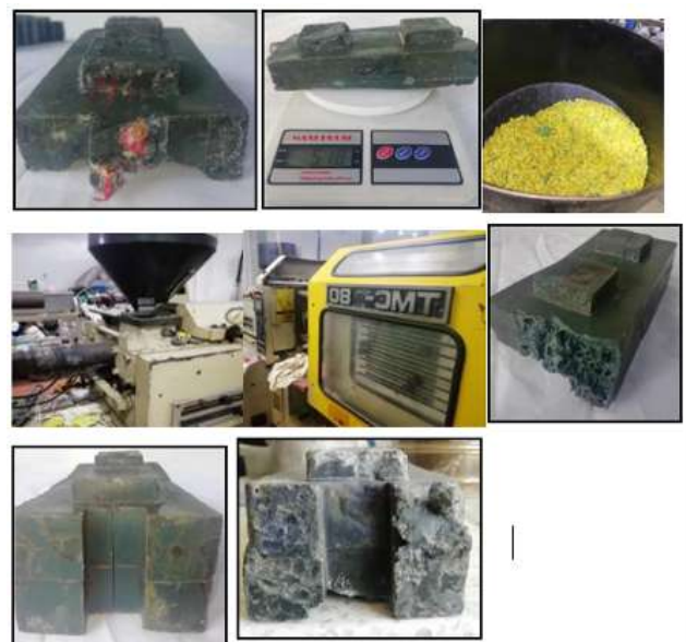
Figura 6. Ladrillos obtenidos del proceso de fundición manual
