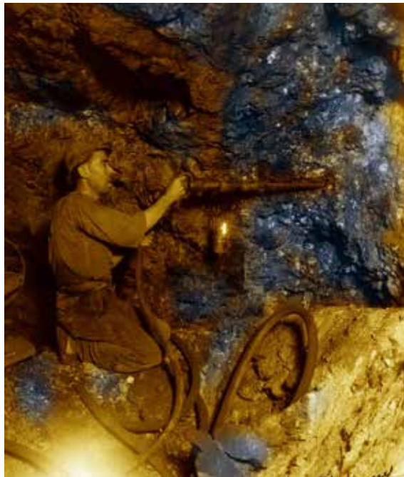
Martillero, perforando en galería sobre filón
