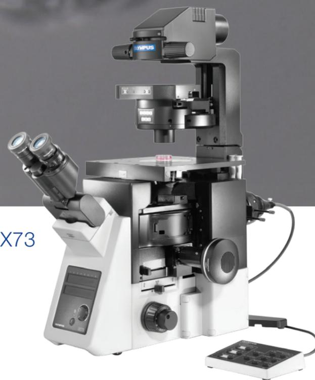
Microscopio invertido semi-motorizado IX73
