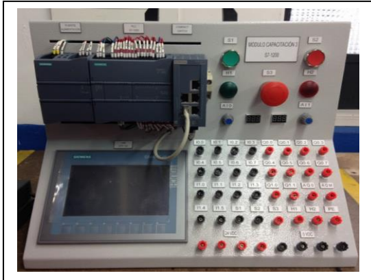
Figura 6. Foto módulos s7 1200: PLC
