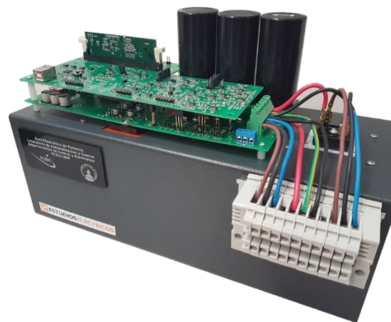
Fig. 7. Vista lateral del CEMP, versión lite para enseñanza de topologías de conversión.
