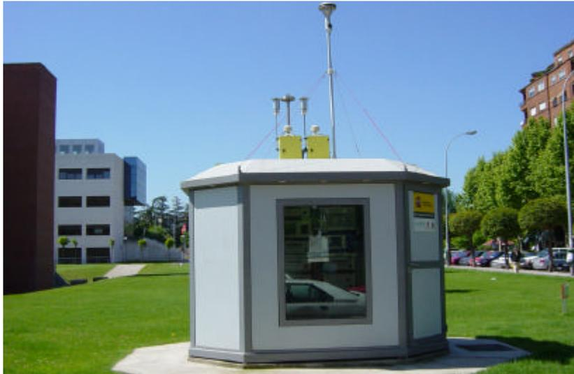
**Fig 7.** Estación de vigilancia de la contaminación del Campus Universitario de Logroño. La estación dispone de medidores de SO<sub>2</sub>, NO, NO<sub>2</sub>, O<sub>3</sub>, CO, Tolueno, Xileno, y Benceno, además de un pluviómetro. Al fondo, en color blanco, el edificio del Rectorado de la UR.
