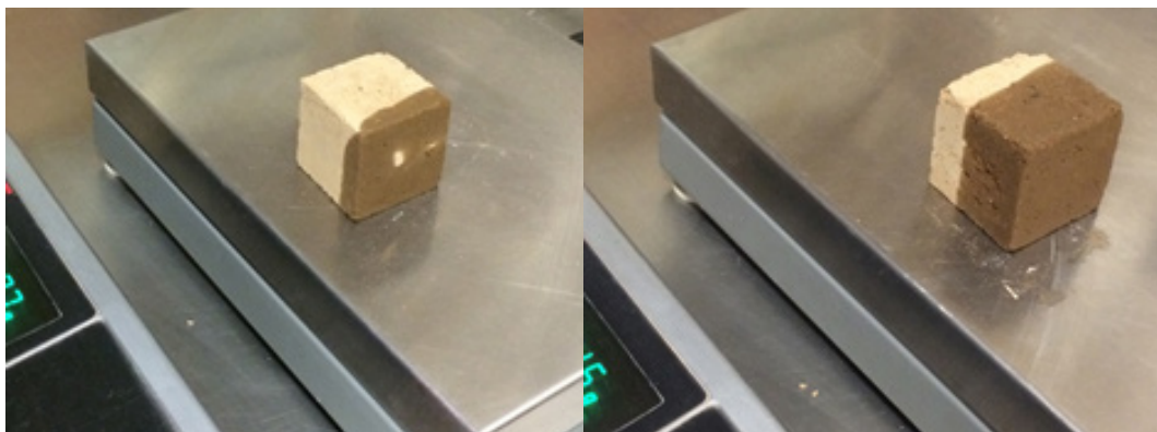
Figura 5: Registro del peso de las probetas cúbicas en periodos controlados, según la Norma Italiana “Normal 11-85” Fuente: Elaboración propia (2018)
