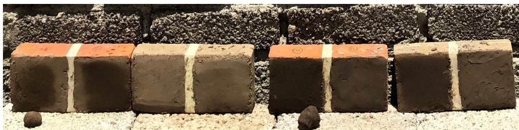
Figura 6: Evaluación de los revestimientos aplicados sobre diferentes tipos de bloques y dejados a la intemperie Fuente: Elaboración propia(2018)
