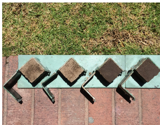
Figura 4: Dos probetas cúbicas realizadas con agua (izquierda) simultáneamente a las mezcladas con la solución de glicerol (derecha), después de tres horas de secado
