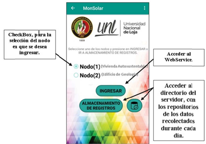
Fig. 11. Actividad o interfaz consulta de base de datos en la aplicación MonSolar.
