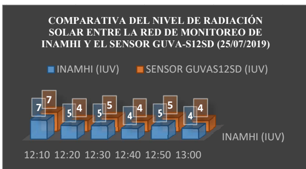
Fig. 16. Gráfica del IUV obtenido, entre INAMHI y el sensor GUVVA-S12SD, en función de las 12 horas del día (clima: semi-soleado y nubloso).
