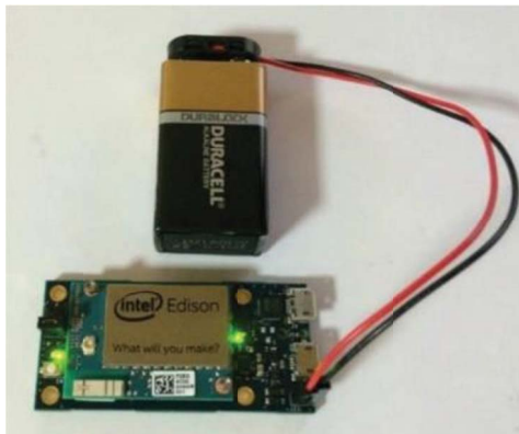
Fig. 1. Tarjeta de desarrollo Intel Breakout.
