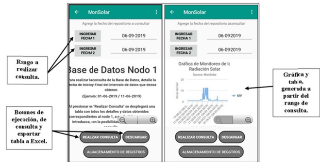
Fig. 12. Interfaz del WebView. Ingreso del rango de datos a consultar, en función de la fecha. Grafica y tabla generada, de los datos obtenidos a partir del rango ingresado.
