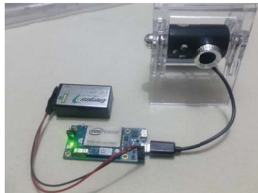
Fig. 3. Nodo sensor implementado.
