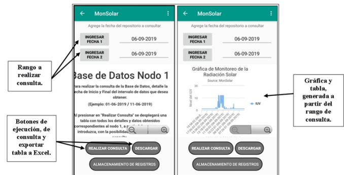
Fig. 12. Interfaz del WebView. Ingreso del rango de datos a consultar, en función de la fecha. Gráfica y tabla generada, de los datos obtenidos a partir del rango ingresado.
