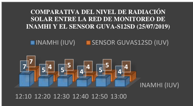
Fig. 16. Gráfica del IUV obtenido, entre INAMHI y el sensor GUYA-S12SD, en función de las 12 horas del día (clima: semi-soleado y nublado).
