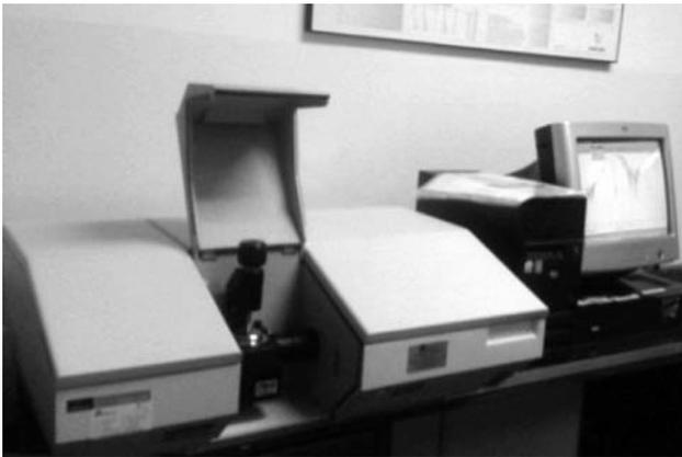
**Figura 3. Equipo FT-IR Perkin Elmer BX**
