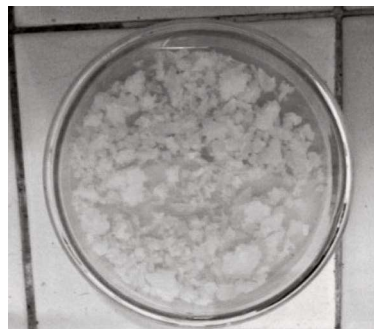
Figura 7. Cristales de clorometilfenilsulfona obtenidos experimentalmente
