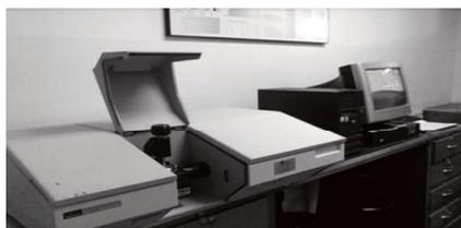
Figura 4. Equipo FT-IR Perkin Elmer BX
