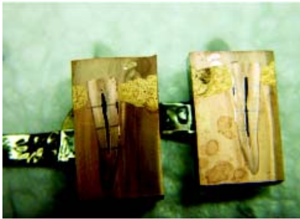
Foto 7. Muestras recubiertas con oro, listas para ser observadas al SEM.
