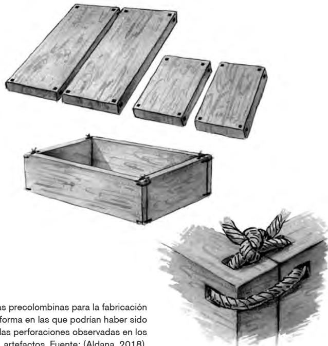
Figura 2: Moldes o gaveras precolombinas para la fabricación de adobes. Se muestra la forma en las que podrían haber sido utilizados de acuerdo con las perforaciones observadas en los artefactos. Fuente: (Aldana, 2018).
